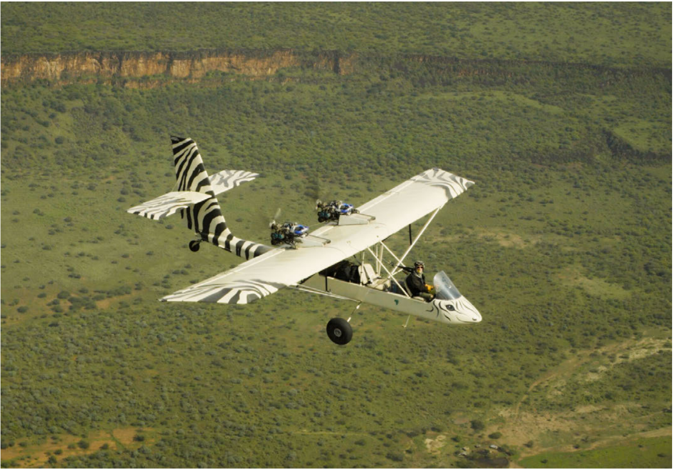
Sa machine de prédilection, l'Aircam... Un avion propulsé par deux moteur Rotax 912 qui a des faux airs d'ULM.
